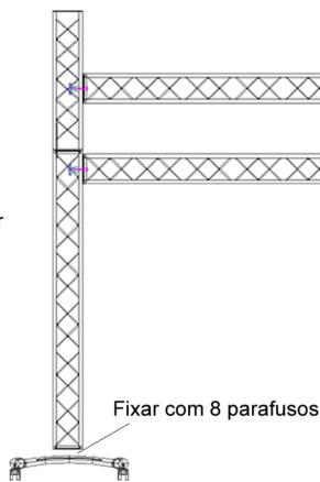
Utilizar os pés niveladores para ajustar o nível da estrutura e corrigir imperfeições do piso.
