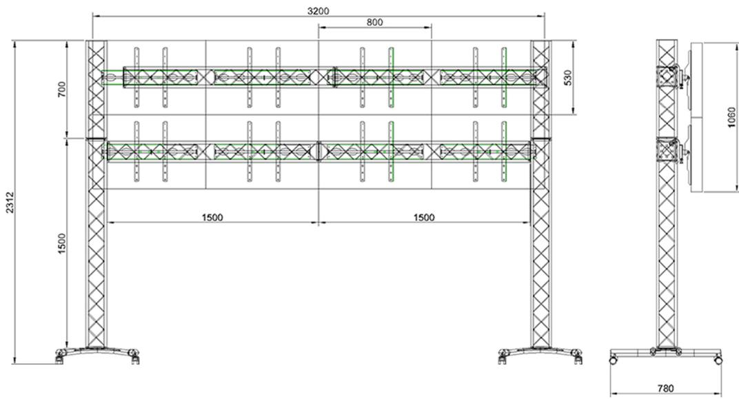
1 Montar a estrutura treliçada deitada para facilitar a montagem. a fixação é feita com manipulos dispensando o uso de chaves. Pré montar dois monitores para ajustar e definir as distâncias.
